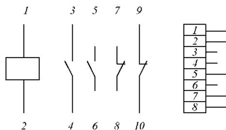
Рис. 2. Изображение использованных и неиспользованных контактов реле
